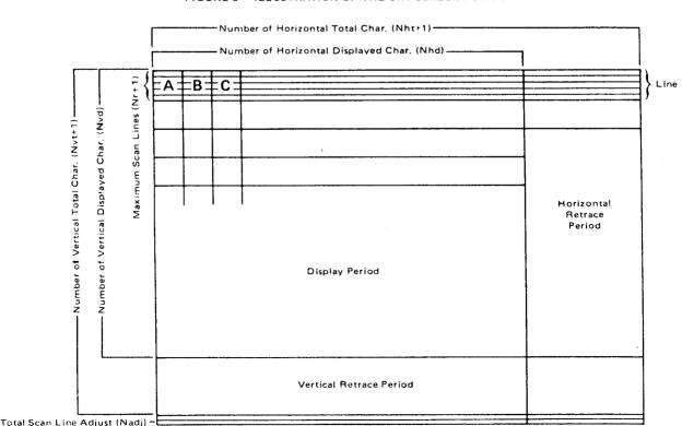
FIGURE 9 - ILLUSTRATION OF THE CRT SCREEN FORMAT
