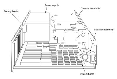
**Figure 13** The IBM XT-286 interior.
