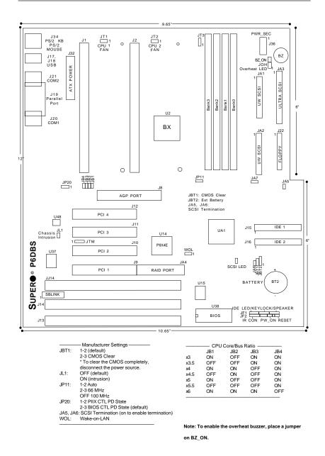
Figure 1-2. SUPER P6DBS Motherboard Layout
